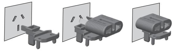
2. 平刃形状コンセント差し込みピンをハの字になるよう回転させてから差し込みます。
