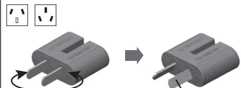
平刃形状ピンをハの字になるよう回転させて差し込みます。
